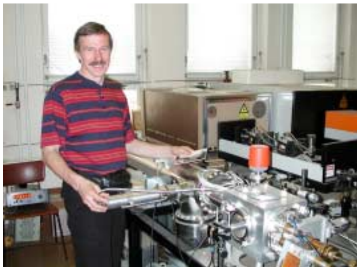
J. Subbi koos täielikult KBFI-s konstrueeritud ja valmistatud MALDI-TOF massispektromeetritega.
