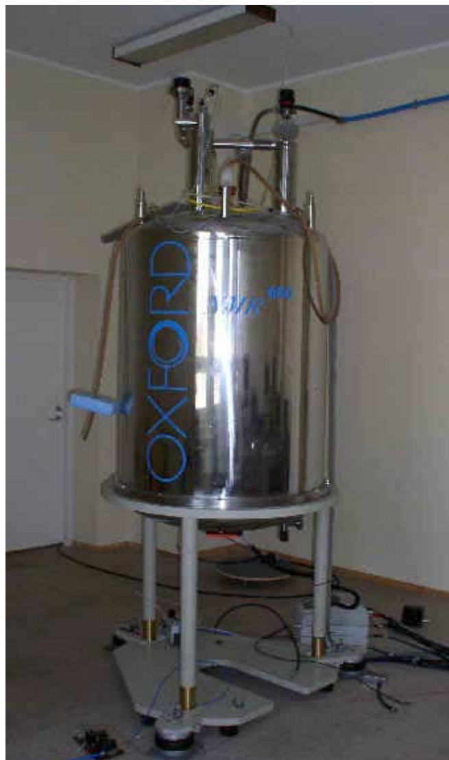
600 MHz-spektromeetri uus Oxford Instruments'i ülijuhtmagnet.
